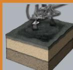
**STEP 2** Une couche de bitume est appliquée par émulsion sur la zone de réparation
